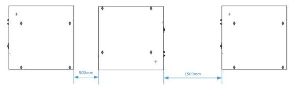
如果柜体周围加围挡,机柜背面与围挡的最小间距为 500mm。机柜正面与围挡的最小间距为 1500mm,以便于安装和维护。
